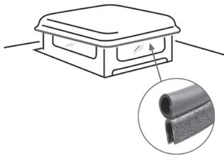
**Dichtung, kleines Dach, Bus T1**
