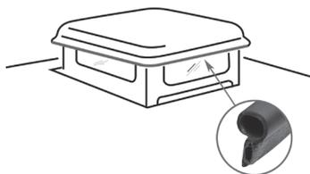
**Dichtung, kleines Dach, Bus T2**
